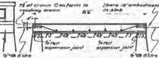
LONGITUDINAL SECTION ALONG C Scale 3/4"=1'-0"
